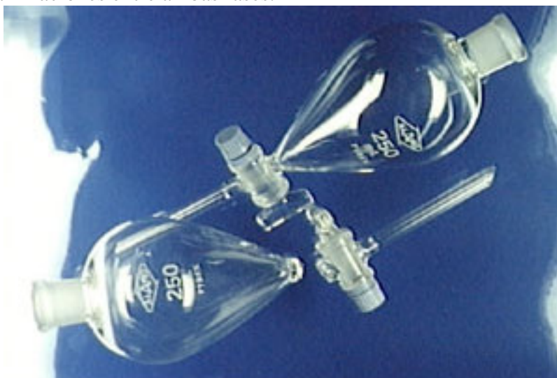
Embudos de decantación
