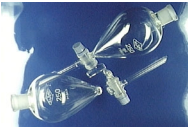
Embudos de decantación
