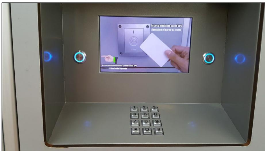
Para la identificación mediante tarjeta, sólo hay que acercar la tarjeta al lector, si la lectura es correcta en el lector aparece una luz verde y se abrirá la taquilla correspondiente.
