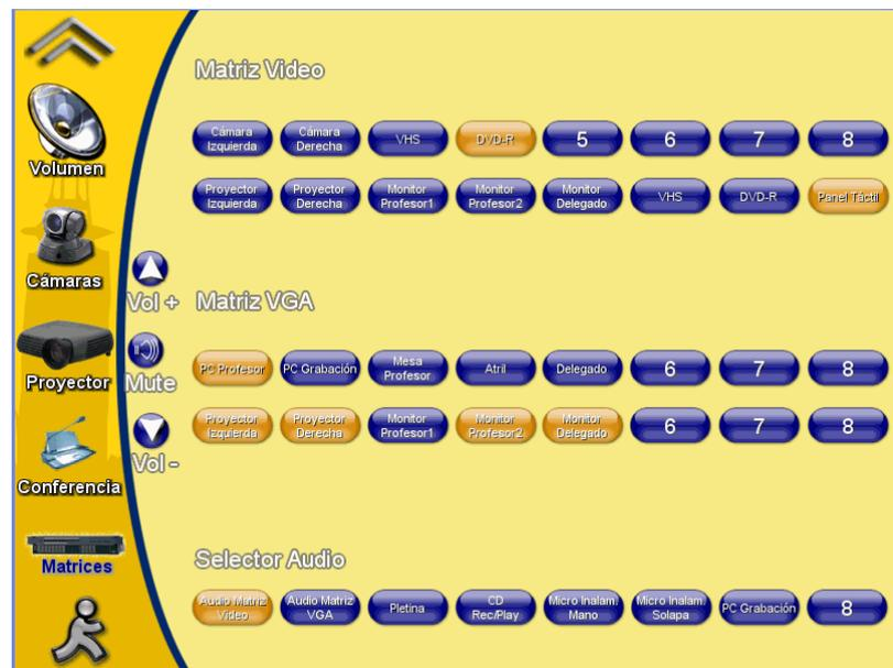
En este menú aparecen tres bloques de teclas, ordenadas en filas, correspondientes a los equipos conectados en las entradas y salidas de las matrices de conmutación y las entradas del selector de audio. Ver el diagrama de bloques del anexo I de este manual.
