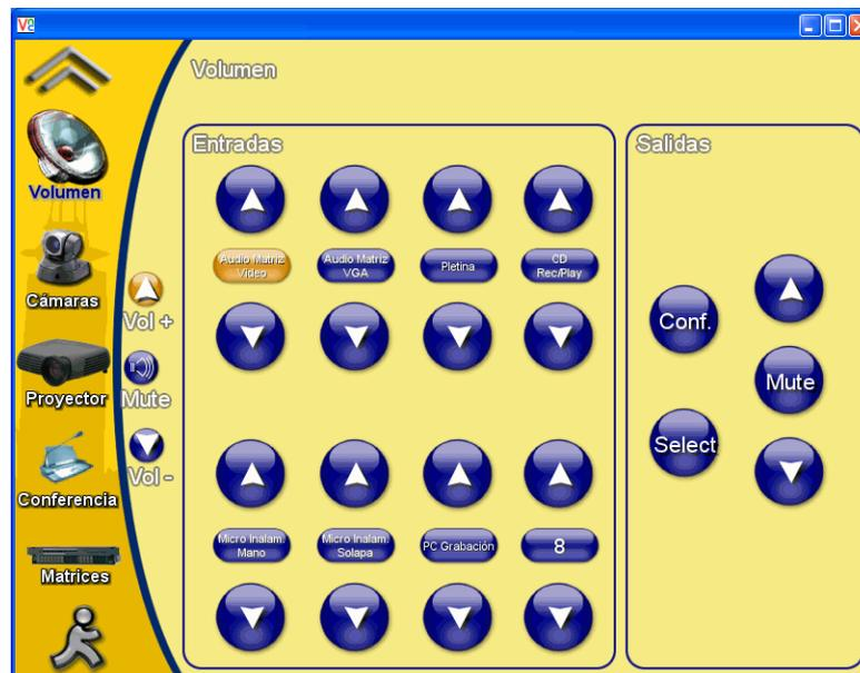
En el recuadro de la izquierda aparecen todas las entradas del selector de audio al que está conectado el sonido de todos los equipos (matriz de vídeo, matriz VGA o de PC's, pletina, CD play, micrófono inalámbrico de mano, micrófono inalámbrico de solapa y PC de grabación).
