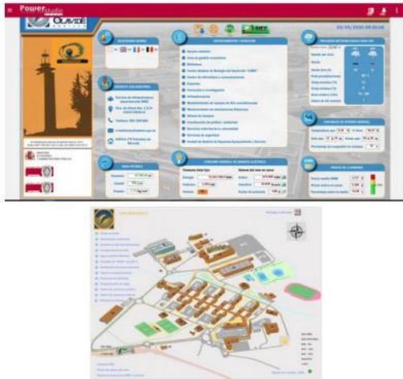
Los consumos en tiempo real son controlados por dispositivos instalados en los edificios. La información es llevada a través de la Red de datos a los servidores donde está instalado el sistema Power Studio, que a través de indicadores (IDEn) se transforman en información útil para la gestión de la energía.
