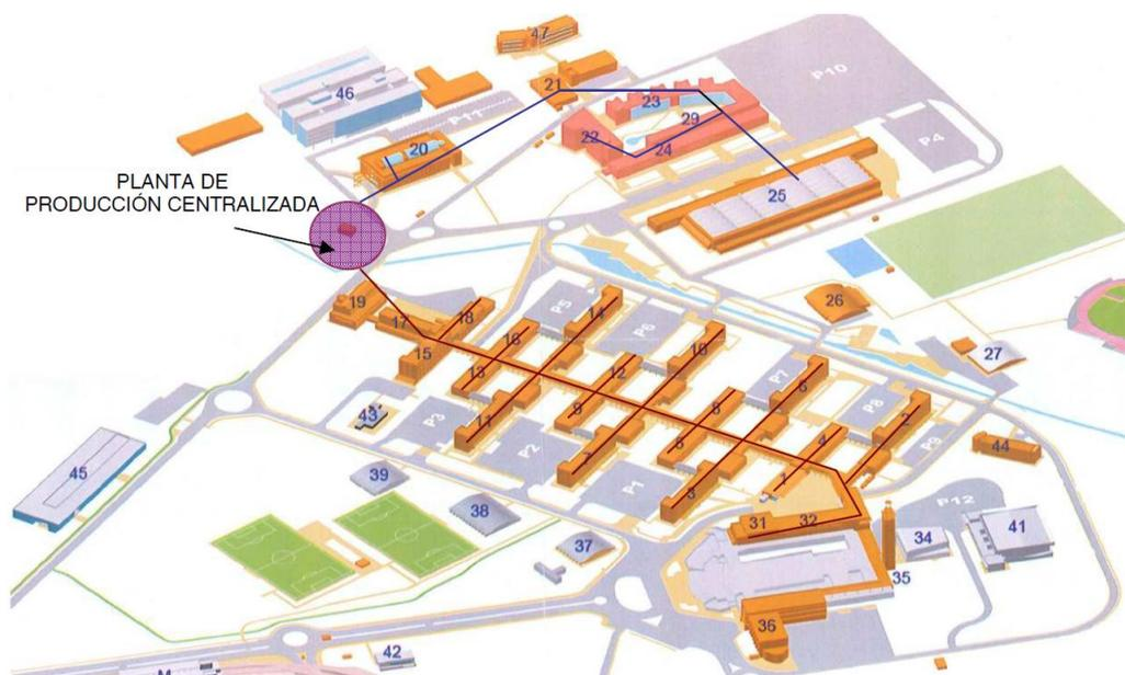
Opción 1: Producción Calefacción y Refrigeración mediante Bomba de Calor
