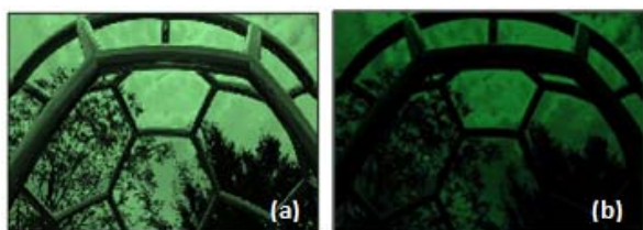
Fig. 3. Funcionamiento de la pantalla LCD de un casco de soldadura (a) en reposo y (b) al soldar
