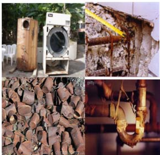
Figura 3 en la que se muestran las consecuencias de la corrosión en lavadoras, edificios, latas y tuberías.
