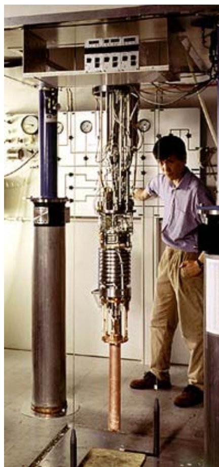
Figura 4. Criostato de campos magnéticos de un centro de investigación finlandés (Laboratorio de Bajas Temperaturas).
