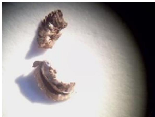
Figura 6. Foto de viruta de la muestra N°4(50 rpm). Arriba: vista de la superficie mecanizada. Abajo: zona de no contacto con la herramienta de corte.
