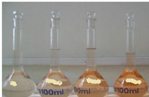
Fig.3. Disoluciones de hierro- o-fenantrolina a distintas concentraciones [14]
