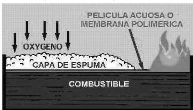
Fig.1 Funcionamiento de las espumas de extinción.
