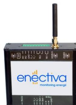
Figura 2. Transmisor encargado de recopilar los datos y enviarlos al servidor.
