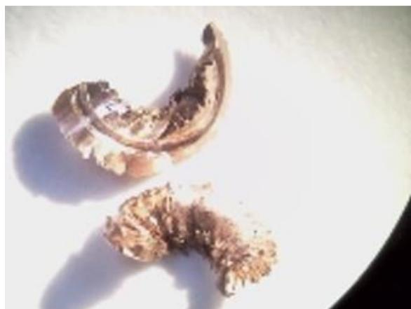
Figura 5. Foto de viruta de la muestra N°3(200 rpm). Arriba: vista de la superficie mecanizada. Abajo: zona de no contacto con la herramienta de corte.
