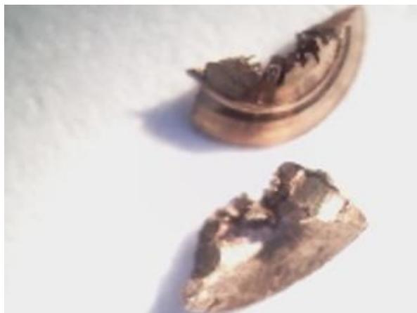
Figura 3. Foto de viruta de la muestra N°1(1200 rpm). Arriba: vista de la superficie mecanizada. Abajo: zona de no contacto con la herramienta de corte.
