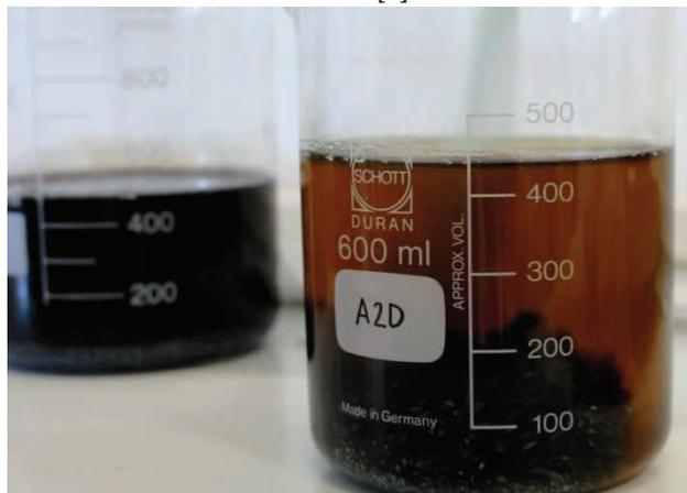
Fig. 2. Reacción al añadir el sulfato de hierro con el ácido gallotánico, produciendo el color oscuro. Fuente: Sara Peiró Prades
