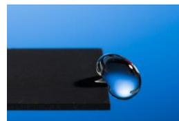
Fig.4. Imagen real de una gota de agua al impactar sobre la superficie de un metal con microranuras [14].
