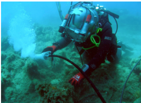
Fig. 4. Buzo inspeccionando mediante LIBS el pecio de San Pedro de Alcántara [6].
