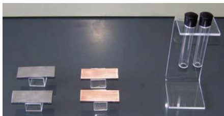
Fig. 1. A la izquierda, probetas metálicas; a la derecha, captadores pasivos. Imagen extraída de la ref. [6].
