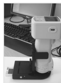
Fig. 2 y 3. Espectrofotómetro UV-VIS Jasco V-670 (Dpto. Química inorgánica y orgánica, Universitat Jaume I) y Fig. 2. Espectrofotómetro/colorímetro Konica Minolta (IVC+R). Foto: M. Pastor.
