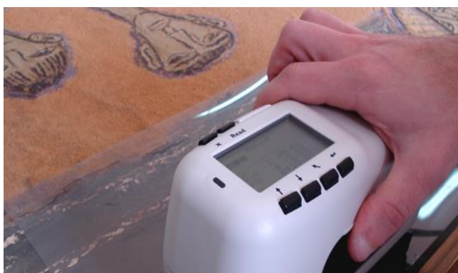
Fig. 1. Evaluación de los cambios ópticos tras la consolidación de El vendedor de cocos de Salvador Soria, (Ateneo Mercantil de Valencia) en el IVC+R con un colorímetro X-Rite®. Foto: M. Pastor.
