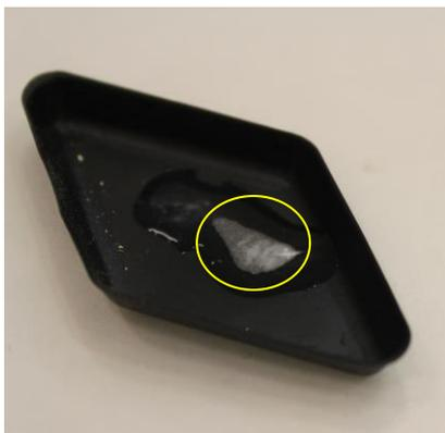
Fig. 4. En la imagen se muestra la caracterización de un aglutinante pictórico mediante análisis microquímico. En un recipiente se ha colocado la muestra pulverizada, se le ha añadido el agente saponificante ( $\text{NH}_3$  al 30%) y seguidamente el oxidante ( $\text{H}_2\text{O}_2$  al 30%). Al incorporar este último se ha generado una efervescencia más o menos prolongada (señalada en la fotografía con un círculo amarillo) que revela la presencia de un ligante graso (fuente propia).
