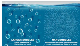
Fig. 4. Comparación del movimiento de las burbujas convencionales y las nanoburbujas [1].
