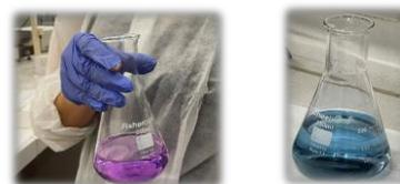
Figura 3. a. Coloración del NET en el punto final de la valoración
