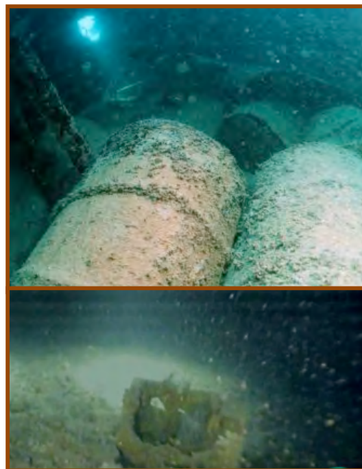
Figura 2. Bidones en el lecho marino oxidados y agrietados por la corrosión 1 .
