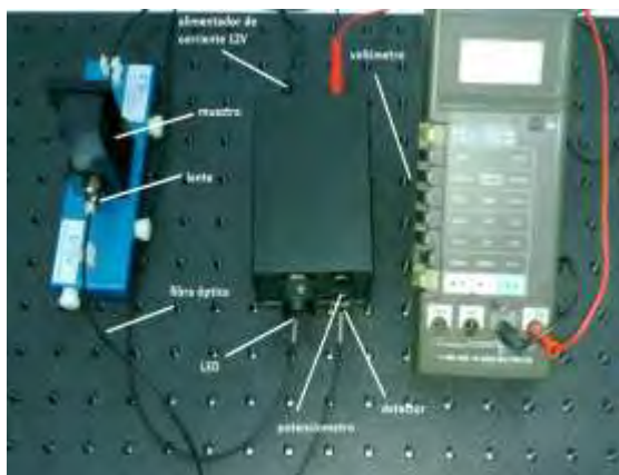
Figura 3. Representación del equipo de medida utilizado para la determinación de Fe (II).
