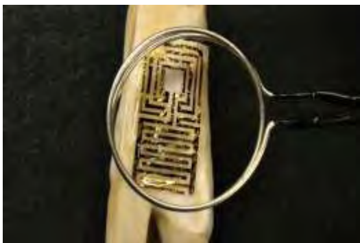
Figura 2. Primeras implantaciones de sensores de grafeno en dientes de vaca. 4
