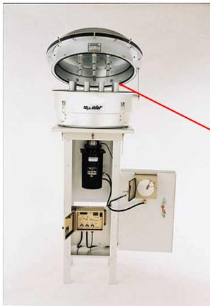
Cilindros calibrados por alturas para seleccionar por tamaños
