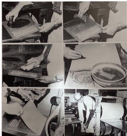
Fig. 17. Proceso de estampación. (Fotografía de Fábrica de Cerámica de La Cartuja de Sevilla (F. C. S.) en Maestre de León, 1993).
