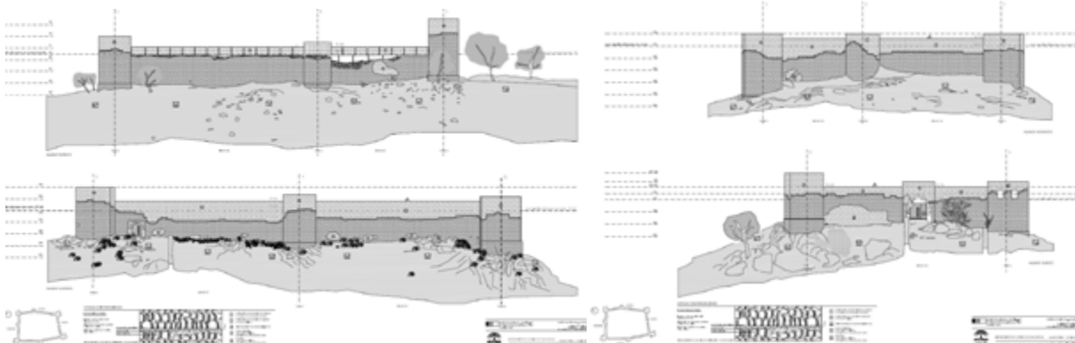
Proyecto de estado reformado, alzados exteriores NE y SO, y alzados exteriores NO y SE proyecto de 2007, Rafael Herrera Limones y estudio de arquitectura republica_dm, procedentes de Delegación Territorial en Huelva de la Consejería de Cultura, Junta de Andalucía
