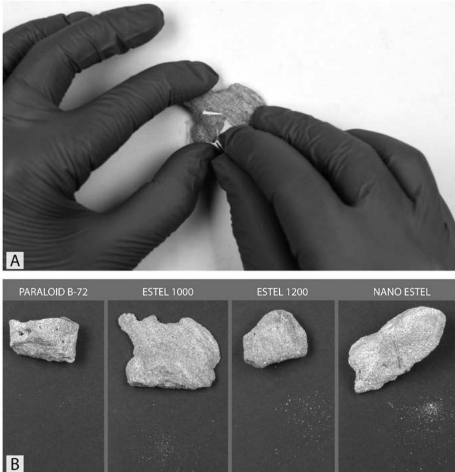
**Fig. 16.** Ensayos de evaluar de resistencia mecánica de muestras de sedimentos tratadas: *peeling test* (A) y muestras tras la prueba de abrasión superficial donde se aprecia el desprendimiento de material (B) (Fotografías: Autores).
