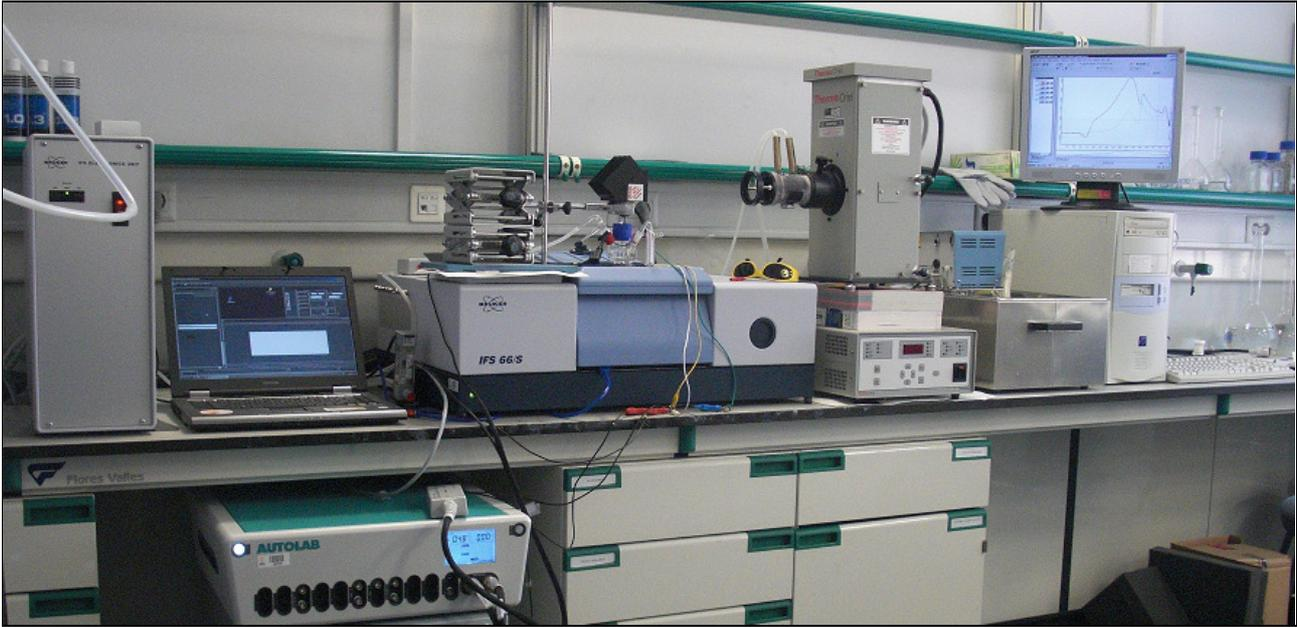
**Espectrómetro Bruker IFS 66/S FTIR. Lámpara de Xenon-Hg 450 W. Potenciostato Autolab/PGSTAT302N**
